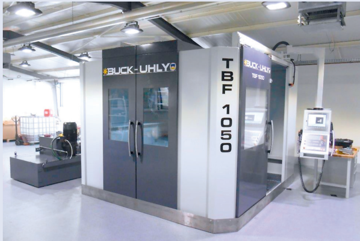
Das ist das neue Schmuckstück der Firma Heidler (Hydraulikbau) aus dem Langgönser Ortsteil Oberkleen. Es handelt sich dabei um eine CNC-gesteuerte Tieflochbohrmaschine, die dabei hilft, vier Fertigungsseiten in einer Aufspannung zu bearbeiten, aufwendige Umspannungen werden in Zukunft damit wegfallen. Nach Angaben der Geschäftsleitung kostet die neue Maschine weit über 300 000 Euro. Foto: Volkmar Köhler
